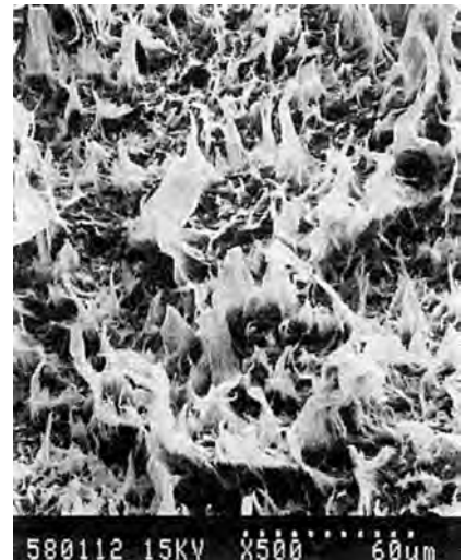
写真3 ポリアセタールコポリマーのクリープ破面
